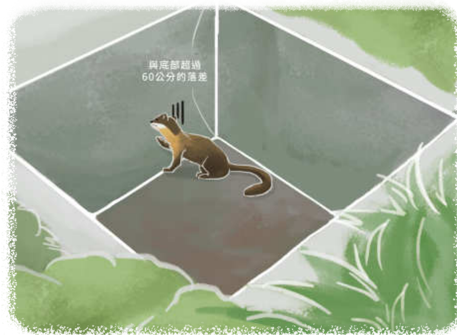
集水井 / 靜水池示意圖。野生動物易因高低落差受困。
